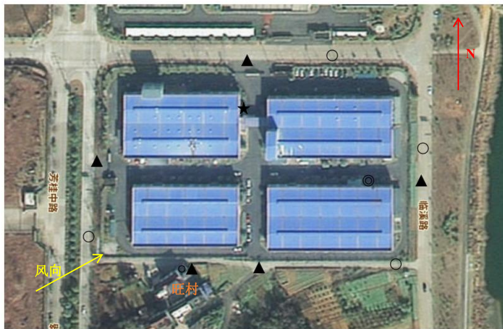
▲ 表示噪声监测点 ★ 表示废水监测点 ● 表示有组织废气监测点 ○ 表示无组织废气监测点 ○ 表示环境空气监测点
